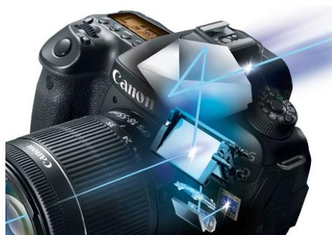
Beim **optischen Sucher** einer EOS DSLR-Kamera wird das Motiv durch das Objektiv und dann über einen Spiegel in den Prismensucher umgelenkt. Im Moment des Auslösens klappt der Spiegel hoch, und der Sucher wird für die Dauer der Belichtungszeit dunkel. Im Live-View-Modus hingegen arbeitet eine DSLR ähnlich wie eine spiegellose Kamera: Das rückseitige Display fungiert dann als elektronischer Sucher.
