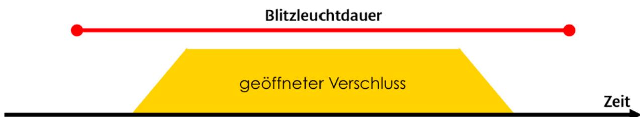
Das High-Speed-Sync- oder HSS-Blitzmodus kann bei hellem Tageslicht mit sehr kurzen Belichtungszeiten eingesetzt werden. Die Blitzleuchtdauer wird dabei so gesteuert, dass sie sich gleichmäßig über die gesamte Belichtungszeit erstreckt. Aufgrund dieser Besonderheit ist die Reichweite beim HSS-Blitz geringer.
