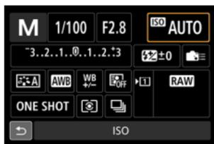
Mit dem **ISO-Wert** bestimmst du die Lichtempfindlichkeit des Bildsensors: Hohe ISO-Werte ermöglichen kurze Belichtungszeiten oder mehr Schärfentiefe durch Abblenden. Niedrige ISO-Werte helfen beim offenblendigen Fotografieren in heller Umgebung.
