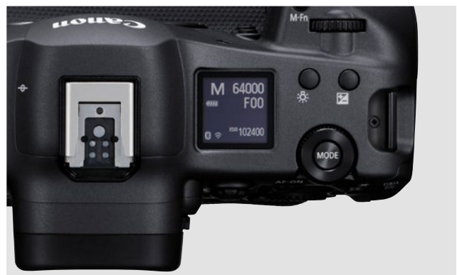
EOS R3: Die hohe Empfindlichkeit von bis zu ISO 102.400 und der Back-illuminated Stacked Sensor ermöglichen kurze Belichtungszeiten, hier 1/64.000s, mit dem elektronischen Verschluss
