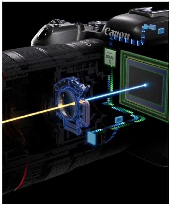
Die IBIS-Bildstabilisierung des Bildsensors (grün) ist im Body der EOS R5 und R6 integriert. Sie ermöglicht im Zusammenspiel mit dem IS-System der Canon RF-Objektive (blau) bis zu 8 Blendenstufen längere Belichtungszeiten und vermindert so Unschärfen durch Verwacklung.
