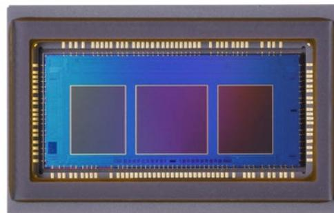
Bei EOS DSLR Kameras ist ein eigener AF-Sensor für die Erfassung der Schärfeninformation zuständig, hier der neue AF-CMOS-Sensor aus der EOS-ID X Mark III.
