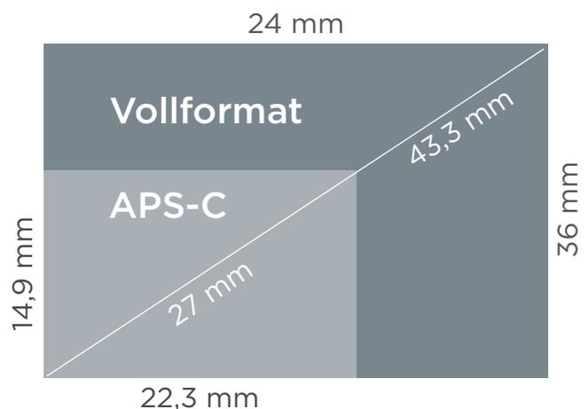
Größenvergleich: Die Fläche des Vollformatsensors ist mehr als doppelt so groß wie die des APS-C-Sensors.
