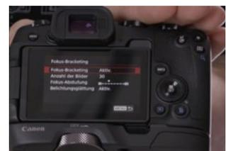
Beim Fokus Bracketing werden mehrere Aufnahmen mit verschiedenen Fokuspunkten in der Kamera zu einem Bild mit erweiterter Schärfentiefe kombiniert.
