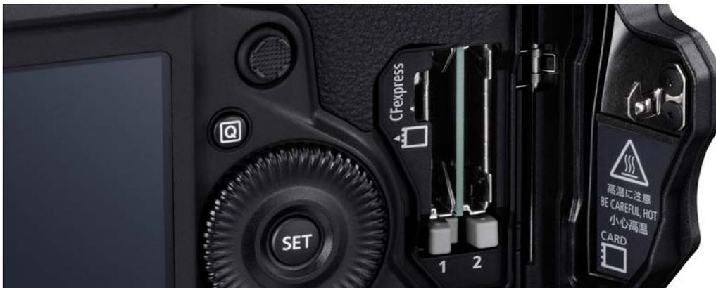
Die Leistungsvorteile der CFexpress Speicherkarten in der EOS-1D X Mark III wurden bereits erwähnt. Die beiden CFexpress Kartenslots, die mit 1 und 2 bezeichnet sind, funktionieren sehr ähnlich wie die bisherigen CompactFlash Kartenslots. Die Karte wird vollständig in einen der beiden Steckplätze gedrückt, um sie einzusetzen. Mit der grauen Auswurfstaste wird die Karte freigegeben und kann dann mit zwei Fingern vorsichtig herausgezogen werden.
